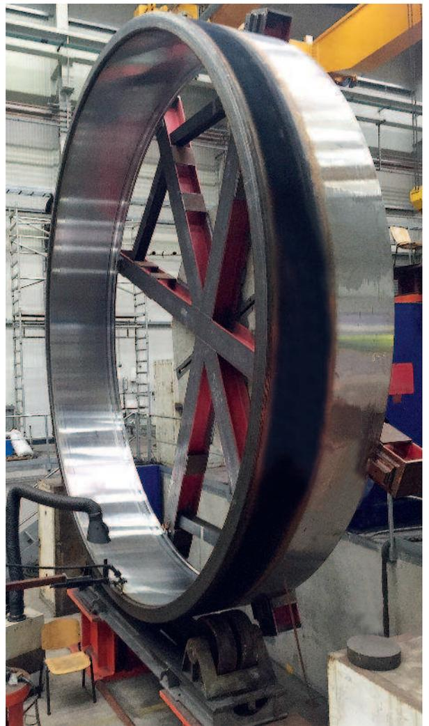
Mit UP - Engspalt-Ausrüstung werden große Wanddicken prüfsicher geschweißt (Wanddicken über 500 mm projektbezogen bereits mehrfach geschweißt).
